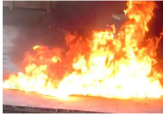
Abb. 7.35: Beispiel einer ausgebildeten Flüssigkeitslache (linkes Bild) auf Beton (Flüssigkeitsvolumen: 0,6 L Benzin) und Entzündung (rechtes Bild)
