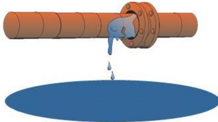
Abb. 7.34: Schematische Darstellung des Szenarios: Bildung einer Flüssigkeitslache durch eine Leckage
