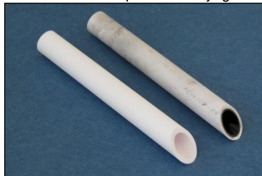
Abb. 1: Verwendete poröse keramische Träger mit Einkanalrohrgeometrie im Ausgangszustand (links) und nach Beschichtung (rechts).
